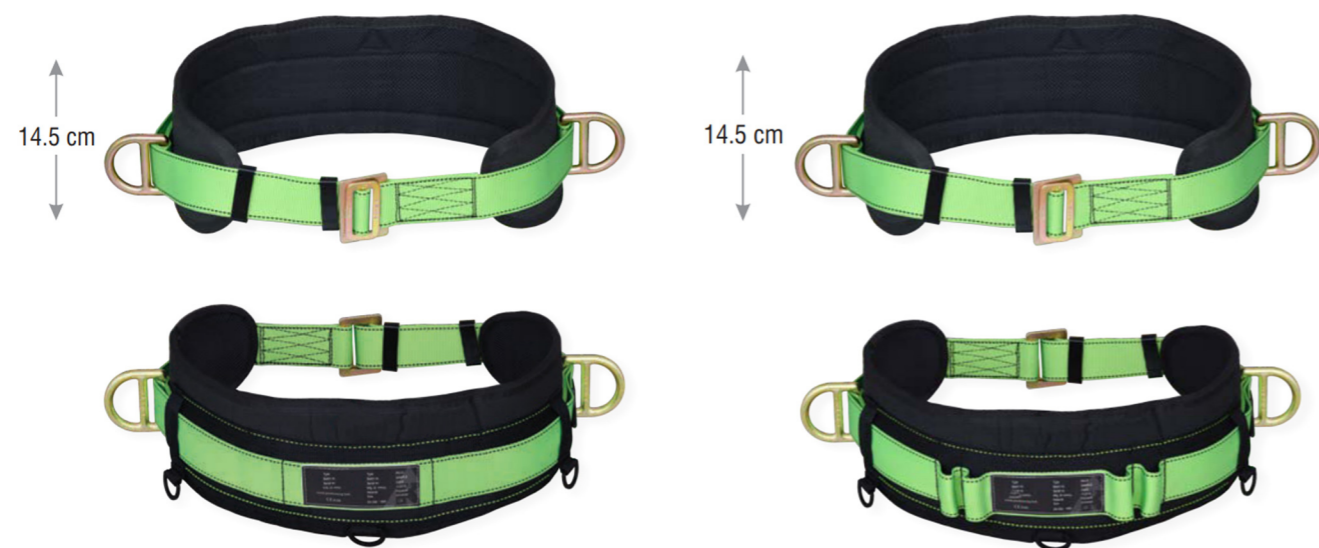
工作定位腰带 符合GB标准 腰垫宽14.5cm 可调节松紧 两个腰侧D型环用来工作定位方便工具放置
