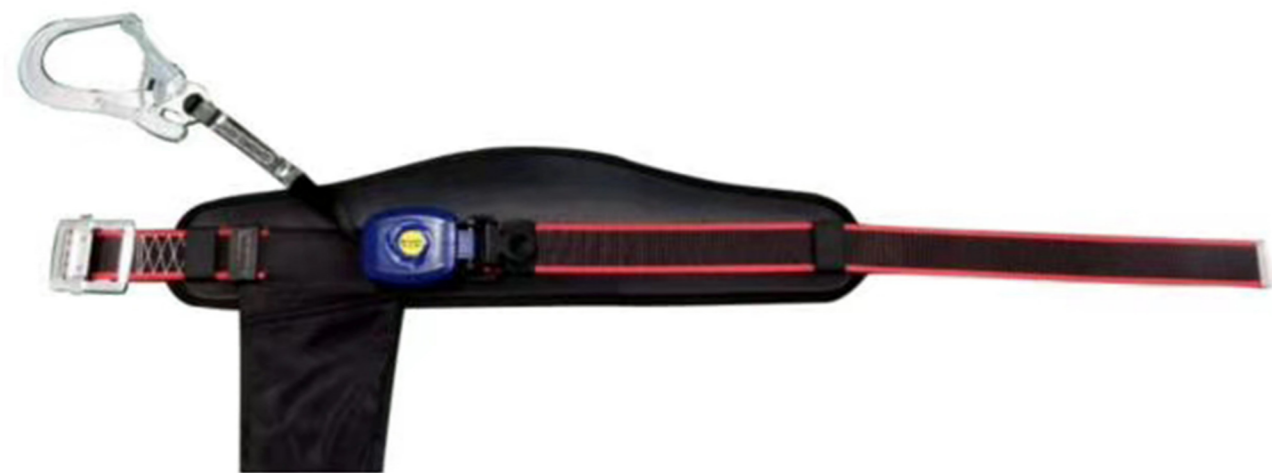
工作定位腰带 符合GB标准 腰垫宽14.5cm 可调节松紧 两个腰侧D型环用来工作定位方便工具放置
